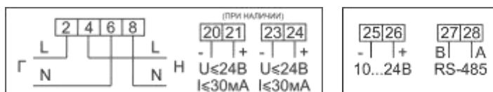
Рисунок Б.7 – Схема включения счетчиков МИРТЕК-12-РУ-D1-xxxx-RS485, МИРТЕК-12-РУ-D4-xxxx-RS485
